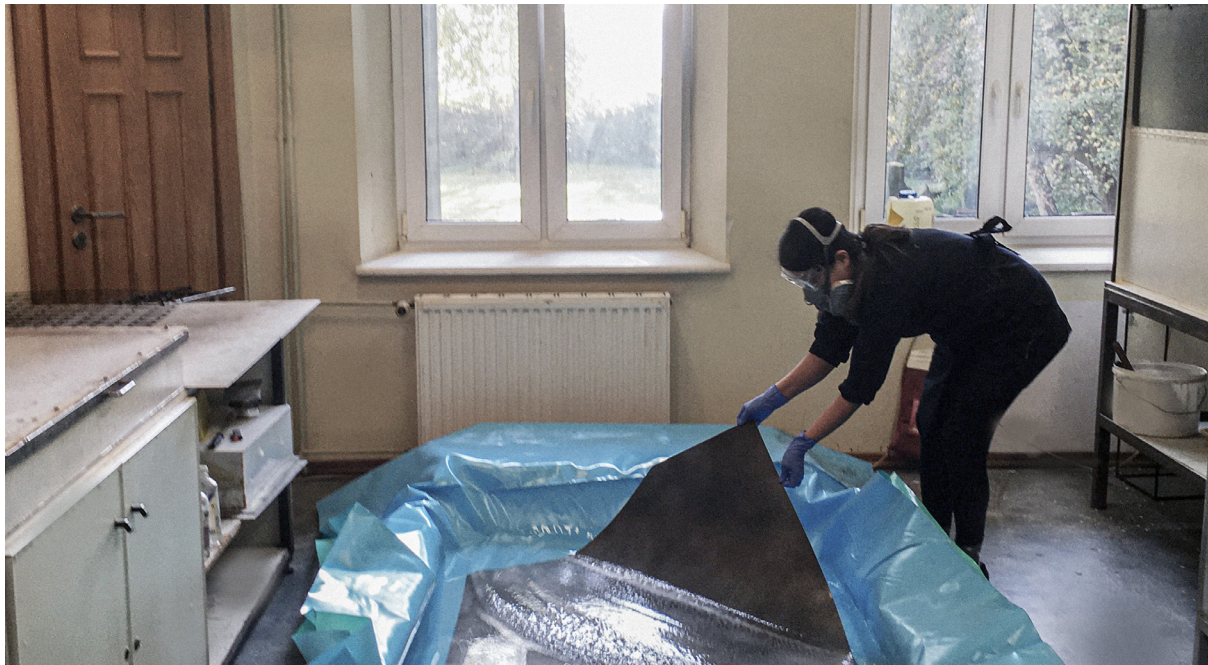
Il. 7. Trawienie płyty cynkowej w wannie z kwasem azotowym. Realizacja obiektu I, 2019 r.
